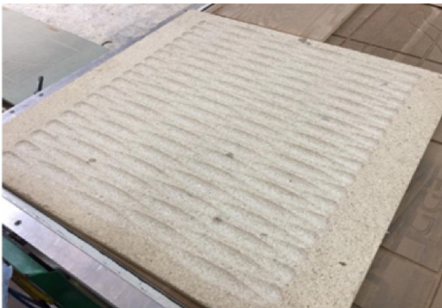
Tekstur papan serpai kenaf yang telah dibuat engraved menggunakan mesin CNC kelihatan kemas dan tidak berbulu
