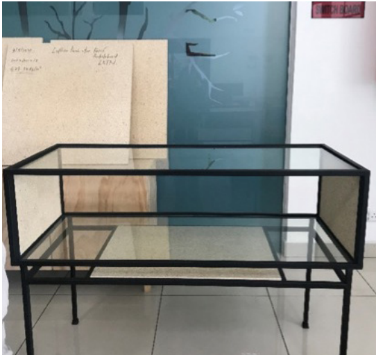
Sampel perabot daripada papan serpai kenaf yang digabungkan dengan elemen besi bagi menghasilkan rekabentuk yang bernilai tambah
