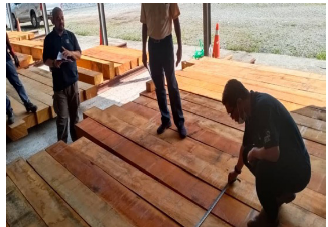
Aktiviti Pemeringkatan Kayu Landasan dan Lintasan Keretaapi (untuk kegunaan ERL) bagi syarikat Durga Timber Trade Sdn Bhd di ERL Station Link (YTL Corp.), Salak Tinggi, Sepang, Selangor
