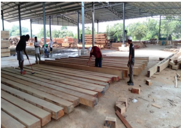
Aktiviti Pemeringkatan Kayu Landasan dan Lintasan Keretaapi (untuk kegunaan KTMB) bagi syarikat Binachuan Sdn Bhd di GS Timber Sdn Bhd, Kulai, Johor
