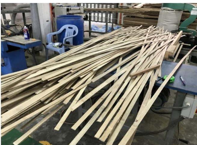
Aktiviti berkaitan sifat kekuatan buluh dalam pembuatan papan laminasi
