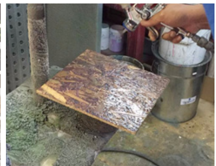
Oriented Strand Board (OSB) yang sedang diuji ketahanannyaterhadap serangan kulat selama 14 hari
