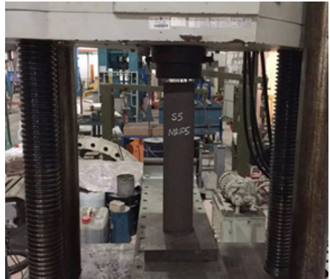
Pengujian mekanikal dijalankan ke atas produk WPC bertetulang logam yang telah siap dihasilkan
