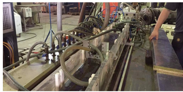
Penghasilan Wood Plastic Composite bertetulang logam ( core extrusion ) untuk aplikasi penggunaan load bearing khusus untuk struktur binaan
