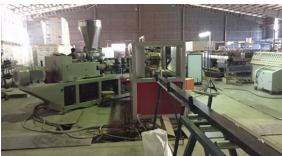
Penghasilan Wood Plastic Composite bertetulang logam ( core extrusion ) untuk aplikasi penggunaan load bearing khusus untuk struktur binaan
