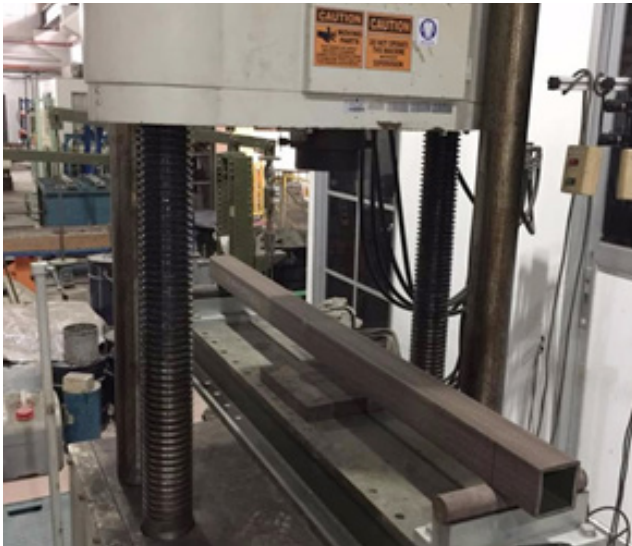
Pengujian mekanikal dijalankan ke atas produk WPC bertetulang logam yang telah siap dihasilkan
