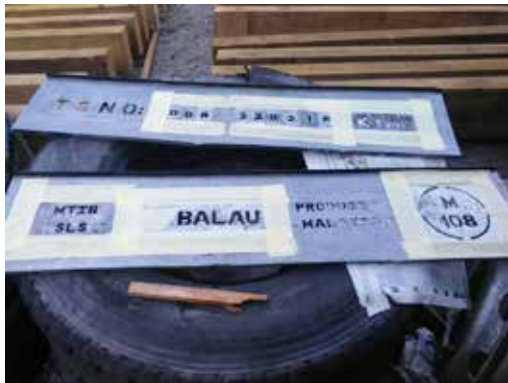
Slot stensil yang digunakan ke atas kepingan kayu yang diperingkat
