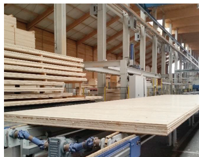
Penghasilan produk CLT (5 layers) oleh Eugen Decker Holzindustrie KG di Morbach, Germany menggunakan teknik "hydraulic press"
