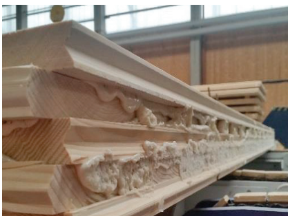
Penghasilan produk CLT (5 layers) oleh Eugen Decker Holzindustrie KG di Morbach, Germany menggunakan teknik "hydraulic press"
